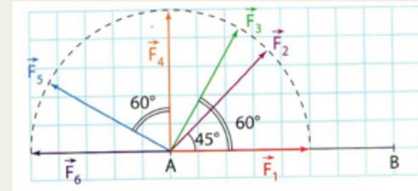
On définit ensuite **le travail  $W$**  d'une force constante  $\vec{F}$  en physique, pour un déplacement rectiligne de A en B, comme le produit  $F \times AB \times \cos(\overline{AB}, \vec{F})$  où  $F$  est en N,  $AB$  en m et  $W$  en J
