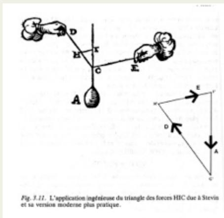
Fig. 3.17. L'application ingénieuse du triangle des forces HIC due à Stevin et sa version moderne plus pratique.
