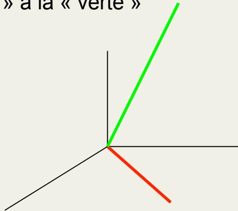
Pour cela il faut trois éléments numériques qui sont les deux angles déterminant le plan dans lequel s'effectue la rotation, et l'angle déterminant la valeur même de l'angle de la rotation.
