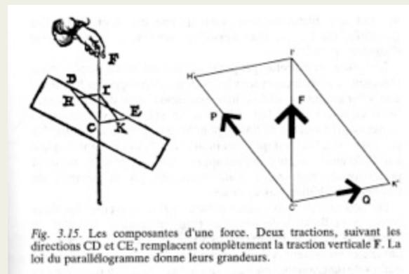
Fig. 3.15. Les composantes d'une force. Deux tractions, suivant les directions CD et CE, remplacent complètement la traction verticale F. La loi du parallélogramme donne leurs grandeurs.
